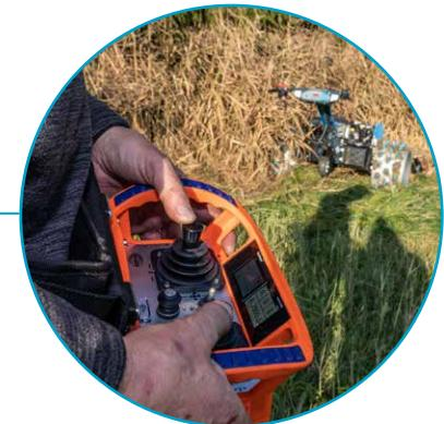
Über die HBC-radiomatic-Funkfernbedienung lassen sich alle wichtigen Funktionen des Brielmaier Motormähers und der angeschlossenen Geräte bequem aus bis zu 100 Metern Entfernung steuern.
