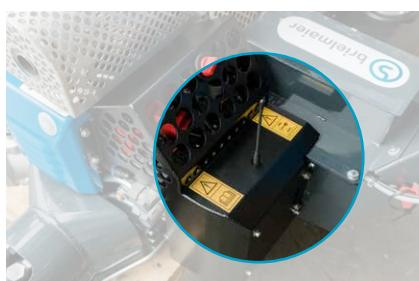
Position des Funkempfängers mit Antenne an der Maschine.
