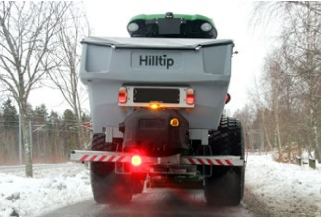
LED Arbeitsscheinwerfer (rot) und Warnlicht (orange)
