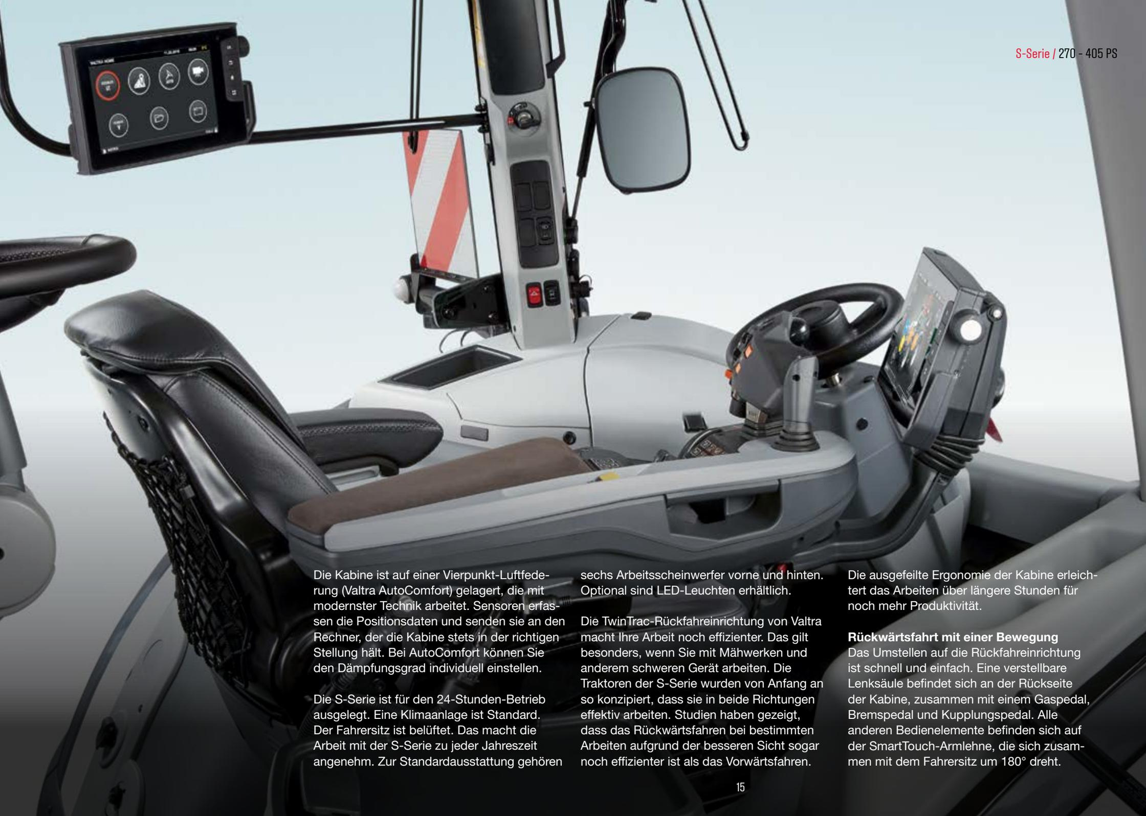
Die Kabine ist auf einer Vierpunkt-Luftfederung (Valtra AutoComfort) gelagert, die mit modernster Technik arbeitet. Sensoren erfassen die Positionsdaten und senden sie an den Rechner, der die Kabine stets in der richtigen Stellung hält. Bei AutoComfort können Sie den Dämpfungsgrad individuell einstellen.
